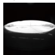
Sản phẩm đạt Camera không bị ảnh hưởng bởi nền, và màng co nhiệt phẳng.
