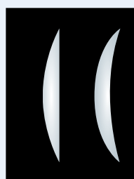
(Trái) Ống kính phi cầu (Phải) Ống kính hình cầu
