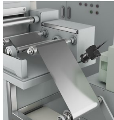
Kiểm tra hình thức ngoài của vật liệu điện cực dương và vật liệu điện cực âm
